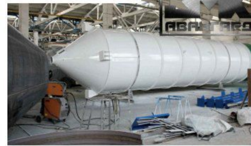
СИЛОСЫ ДЛЯ ЦЕМЕНТА
